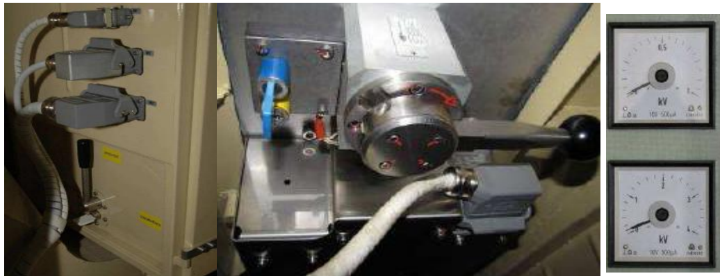
Ovládací páka uzemňovače –Q50 a uzemňovače střešní VN výzbroje –Q02
