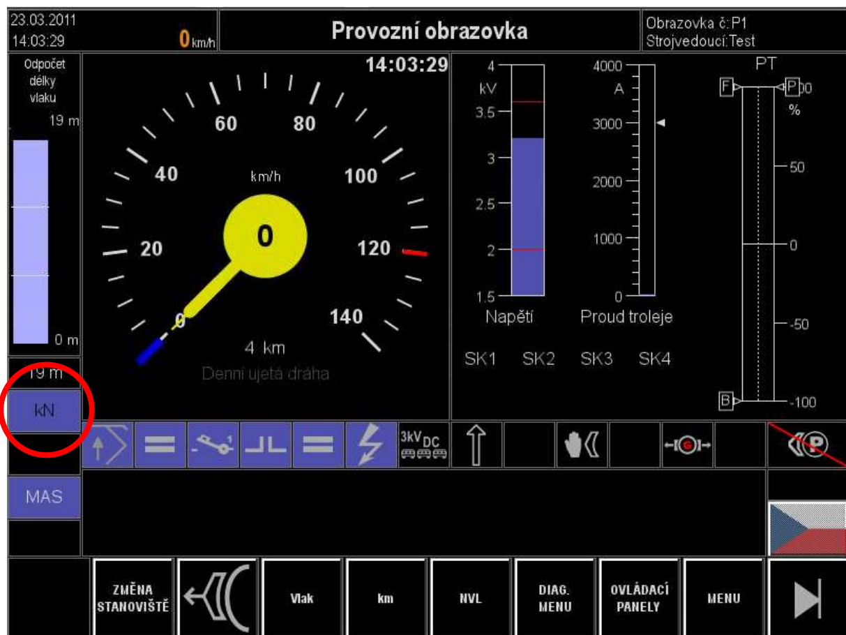
Obr. 33: Ikona „Pohotovost k jízdě“ (obrazovka P1)
