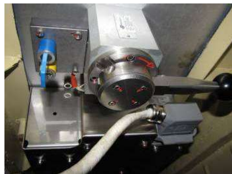
Obr.: Ruční uzemňovač střešní VN výzbroje Q02
